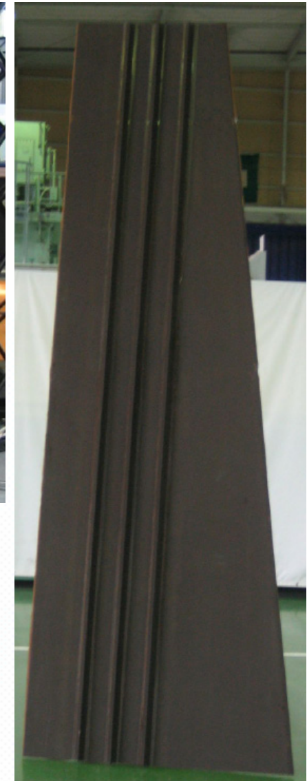
MRJ尾翼(5.5m×1.5m)のカットサンプル (3m×1m)
