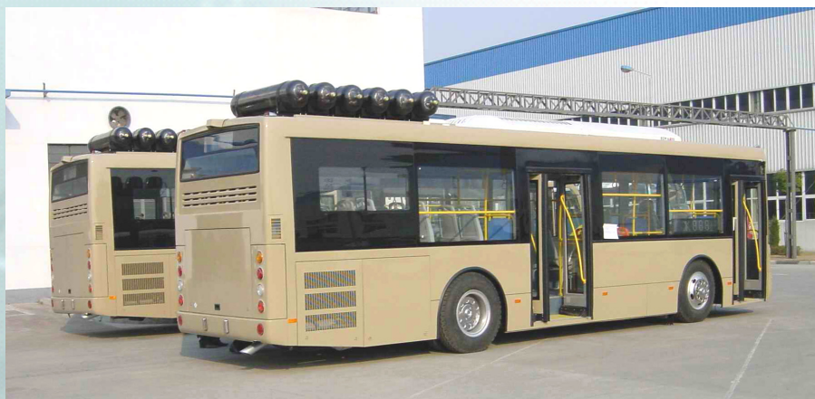
CNG(圧縮天然ガス)タンク
