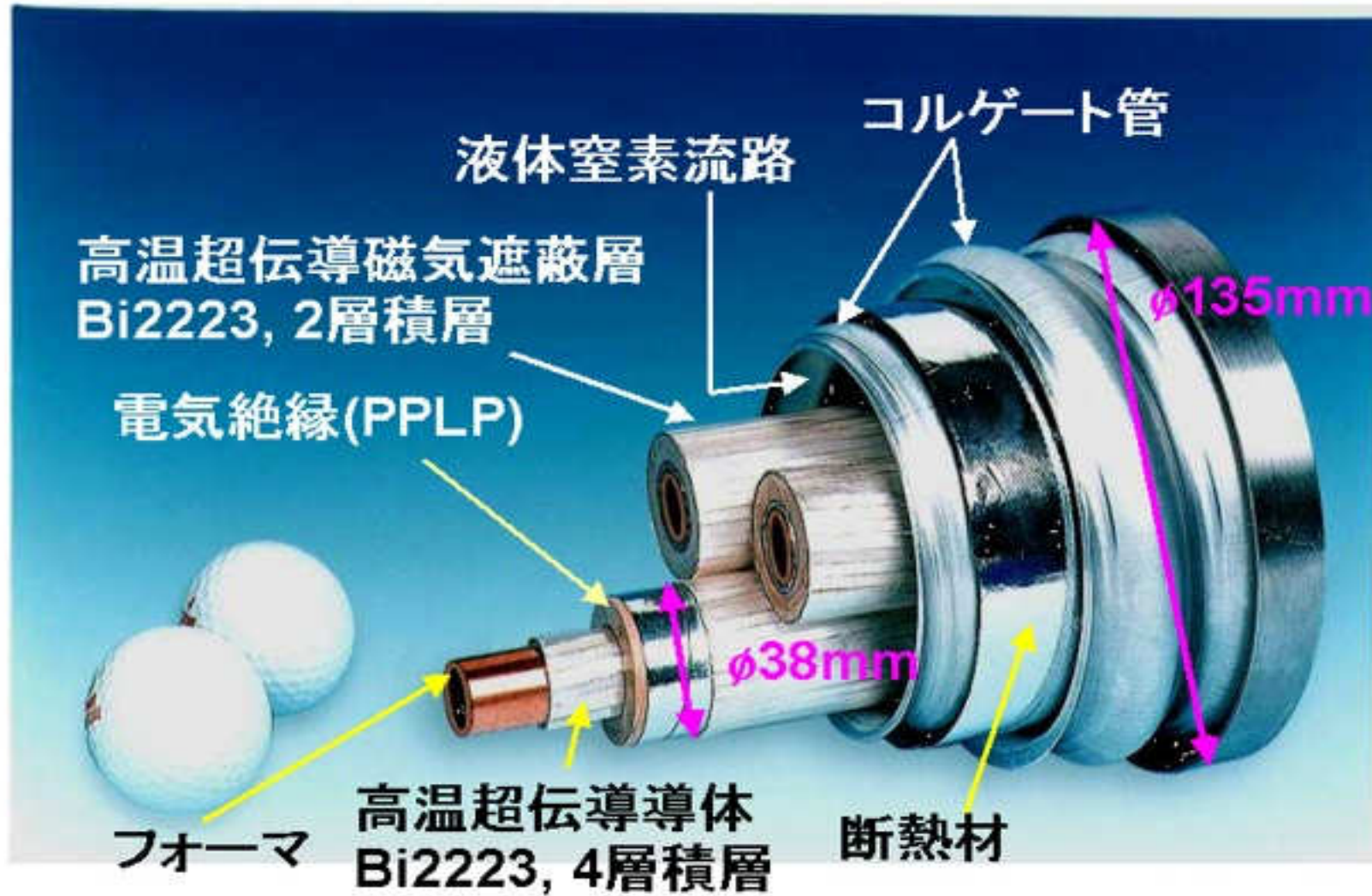
高温超伝導ケーブルの構造（住友電工）
